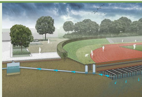
Wasserspeicher unter dem Hein-Klink-Stadion Hamburg (© Naumann Landschaft)
